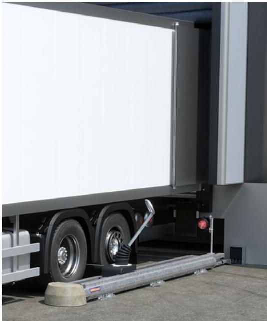
**PROTEZIONE DEI VEICOLI DALLO SPOSTAMENTO.** Anche se l'autocarro è attraccato bene, durante le operazioni di carico-scarico la sua posizione può cambiare, ad es. in seguito alle frenate del carrello elevatore in fase di entrata ed uscita. Il nuovo sistema di bloccaggio ruote MWB2 assicura che l'autocarro non abbandoni involontariamente la posizione sicura di attracco durante le operazioni di carico-scarico.
