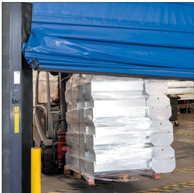
Nessun guasto dopo una collisione grazie alle innovative staffe di guida con manto flessibile
