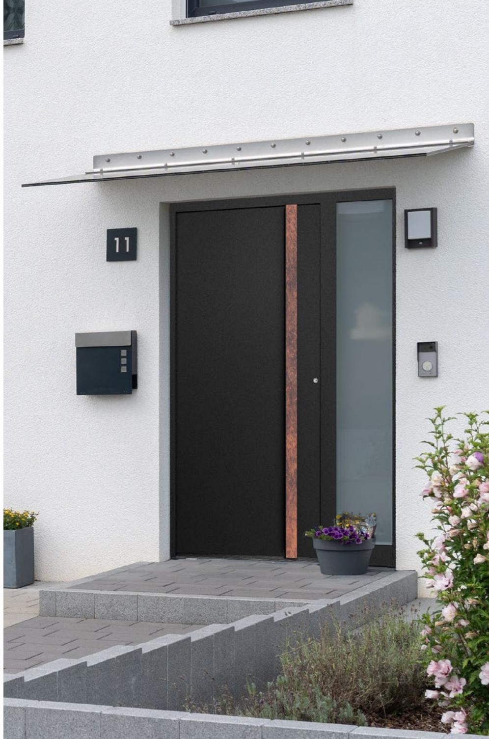
PAGINA 16 / 17. Porta d'ingresso in alluminio ThermoSafe motivo 871, maniglia in acciaio inox HOE 620, nero intenso RAL 9005 struttura fine opaca; portone da garage sezionale greca L, Silkgrain, nero intenso RAL 9005 struttura fine opaca
